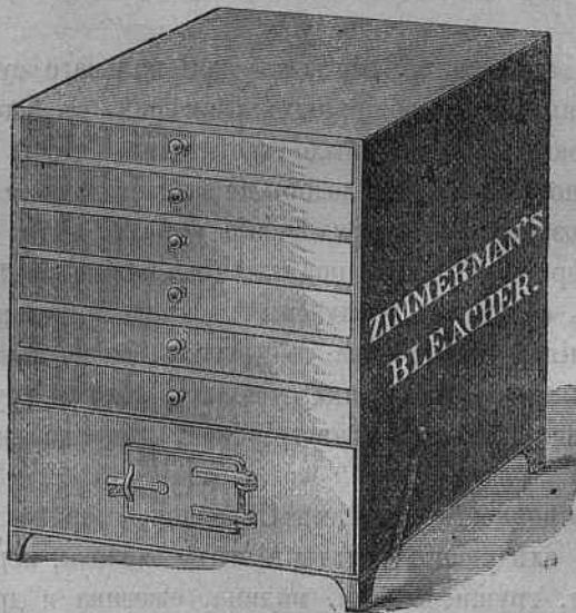
Фиг. 8. Бѣлильный шкафъ «bleasher» Циммермана для окуриванія яблокъ сѣрою.
