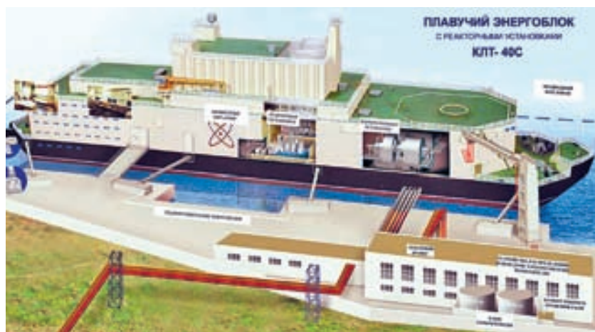
Рис. 3. ПАТЭС с реакторными установками типа КЛТ-40
