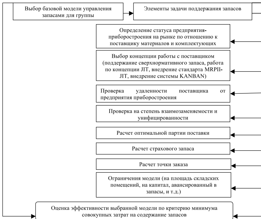
Рис. 1. Общее представление процедуры «разработка оптимизационных моделей поддержания оптимального уровня запасов» на предприятиях приборостроения
